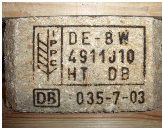
Figur 1 - Behandlet treemballasje er merket etter den samme standarden. Ved siden av IPPC-logoen vises først landkoden, deretter virksomhetsnummeret til produsenten og sist behandlingen, som er enten HT (Heat Treatment), MB (Methyl Bromide Treatment), DH (Dielectric Heating) eller SF (Sulphuryl Fluoride).
