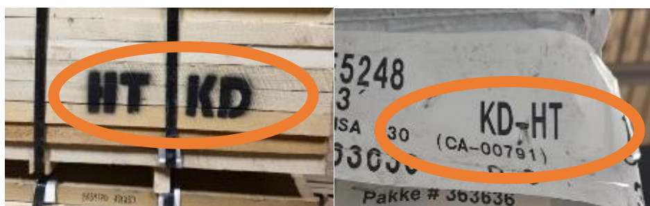
Figur 2 Eksempel på ulike måter å merke behandlingsmåte på. Korrekt merking skal kontrolleres i mottakskontrollen.
