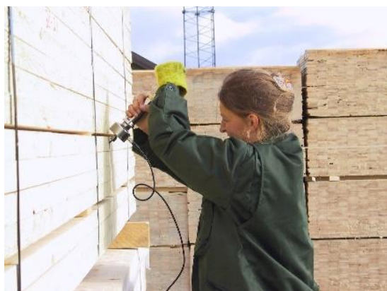
Figur 8 Kontroll av trefuktighet i en importsending.
