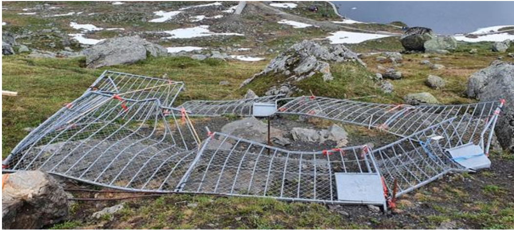
Bilde 3: Grindanlegg på Finse ødelagt av snøtyngde. Bilde tatt 07.08.20. En måned tidligere var området og grindanlegget totalt dekket av snø. (Bilde: Runar Bjøberg)
