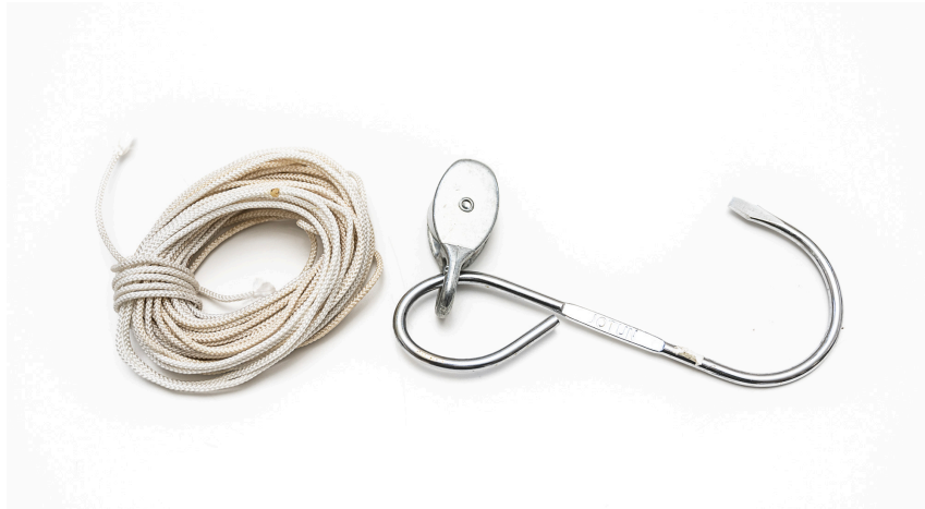
Figur 2. Oppheng for å henge feller på greiner i trekroner. Line, trinse og modifisert malerkrok gjør det lett å heise fellene opp og ned. Kroken henges opp med teleskopstang.
